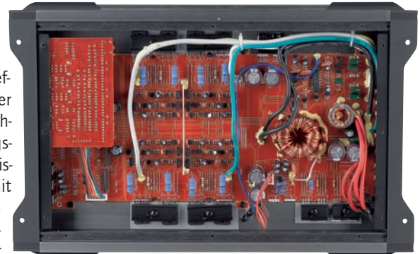
Der Innenaufbau ist solide. Kabelbrücken finden wir im Endeffekt sogar mindestens genauso gut wie Leiterbahnen
