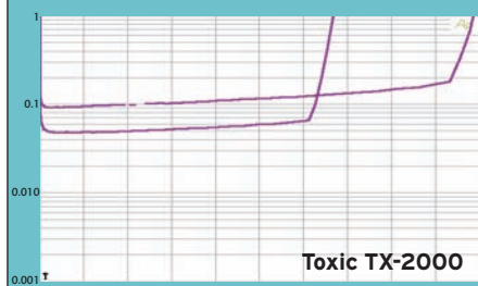
Vorbildlicher Klirrverlauf und steiles Ausscheiden
