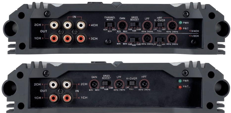
Die Ausstattung beider Endstufen ist im Prinzip gleich, die Kanalanzahl gibt bei der Vierkanal doppelt so viele Regler vor
